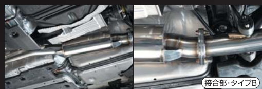
中間ピース タイプB(特殊形状タイプ。当社マフラーフルセットが必要)
